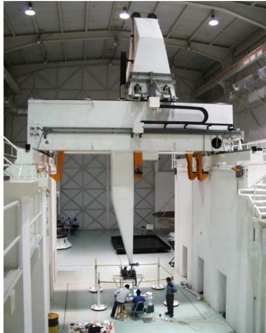
Figura 6.10: La máquina de medición por coordenadas en el INAOE.
