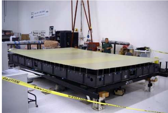
Figura 6.2: Panel de fibra de carbono, una de las opciones para los paneles del GTM.
