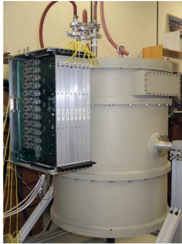
Figura 1.14: El criostato y la electrónica de lectura de AzTEC en el Laboratorio de Aparatos Criogénicos de UMass Amherst.
